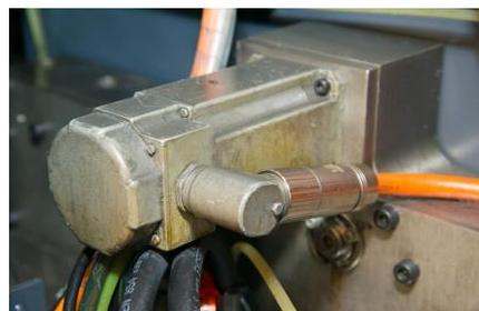
*I motori della serie AKM Washdown posizionano il pezzo da affilare come unità robuste. Meno spazio, minor peso: grazie al sistema di collegamento a cavo singolo si snellisce la procedura di installazione.*
