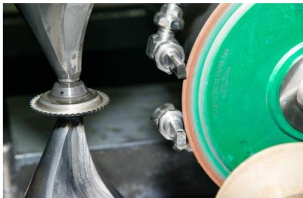
*Con un disco diamantato si provvede all'ultima affilatura delle lame.*
